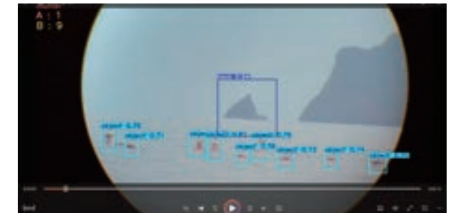
物体検出アルゴリズム YOLO を用いたオオミズナギドリの検出 (動画撮影: 京都府立西舞鶴高等学校)
