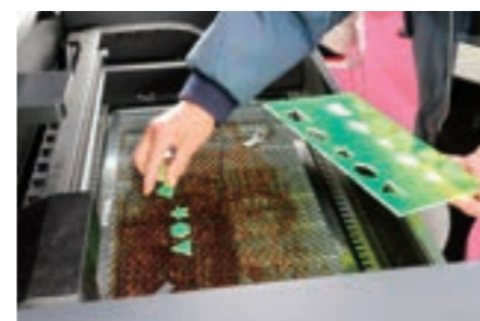
レーザーカッターで加工されたアクリル板
